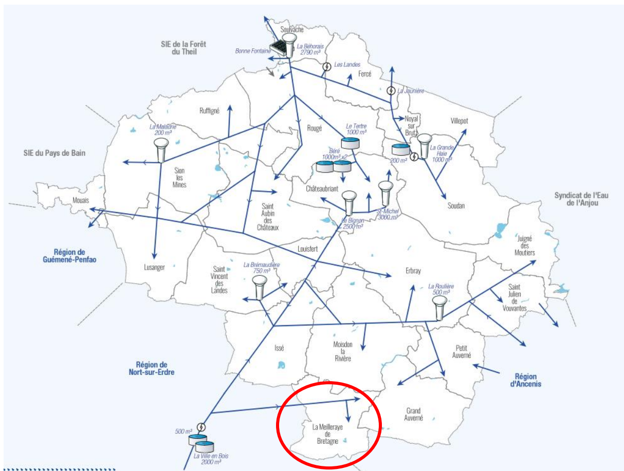
Figure 18 : Schéma de distribution de l'eau potable au sein du SIAEP du Pays de la Mée
